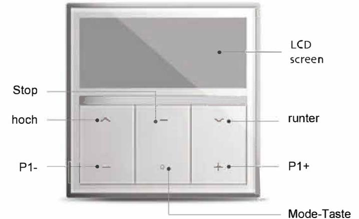
**!** Hinweis: Sender nicht Feuchtigkeit aussetzen. Wenn Sie den Sender verwenden und der Abstand offensichtlich zu kurz oder weniger genau ist, tauschen Sie bitte die Batterie. Bitte entsorgen Sie Batterien nur auf dem dafür vorgesehenen Recyclingweg. Achten Sie darauf, dass beide der Knopfzellen richtig eingelegt sind und die negative Elektrode oben ist.
