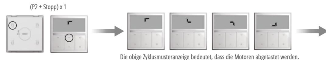
Sobald der Motor gescannt wurde, blinkt der Kanal auf dem LCD-Bildschirm und der gescannte Motor dreht sich zur Erkennung. Wechseln Sie dann zum richtigen Kanal, um den Motor zu programmieren, die anderen Funktionen sind die gleichen wie im normalen Modus.
